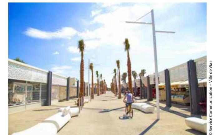
L'avenue de la Méditerranée à Vias (Hérault). Conçus spécialement, les candélabres sont ornés d'un motif en aluminium ajouré et mis en valeur par un rétro-éclairage intérieur bleu. Équipés de luminaires LED à basse consommation, ils offrent également des services connectés Smart-In-Site tels que caméras et haut-parleurs, parfaitement intégrés aux mâts.
